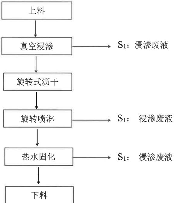
图 2 浸渗线工艺流程及产污环节图
