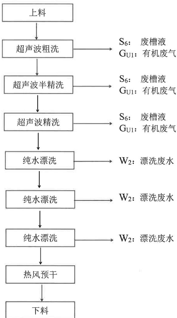
图4 清洗工艺流程及产污环节图
