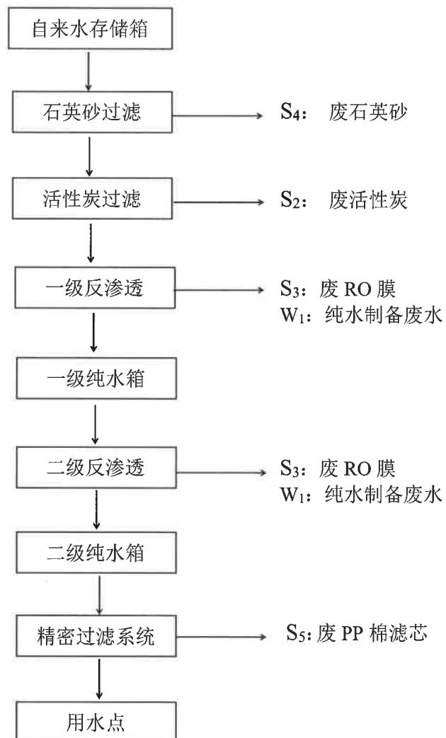
图 3 纯水制备工艺流程及产污环节图
