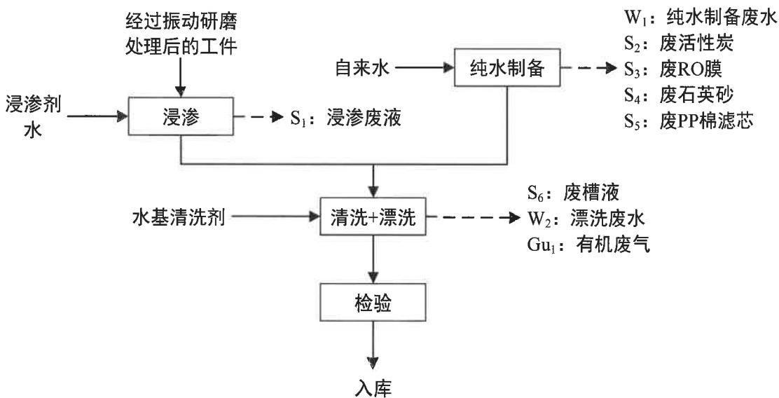
图 1 清洗线技术改造工艺流程及产污环节图
