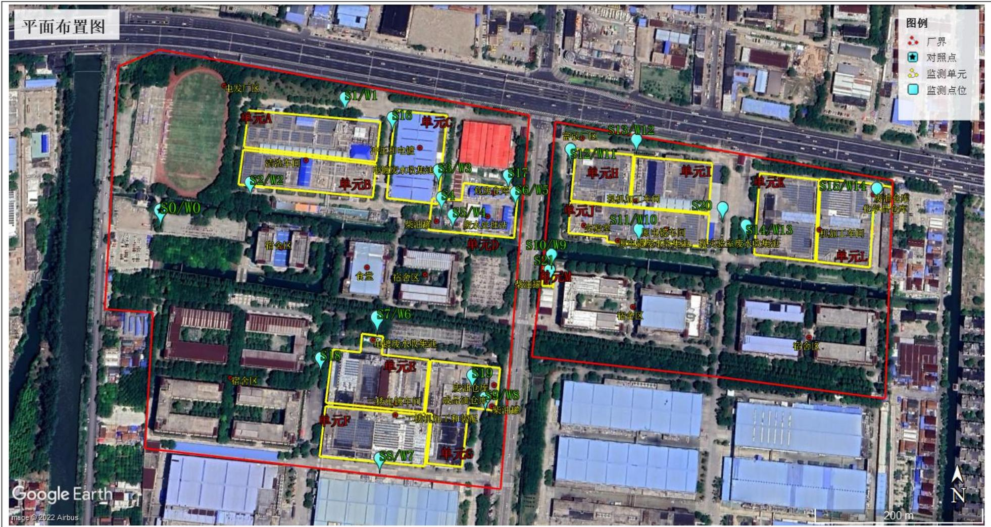
图 6-1 土壤及地下水监测点位布设图
