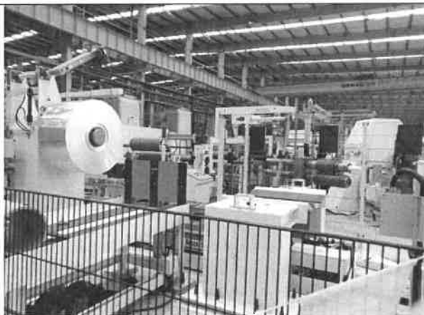
高精度纵剪分切机（精整工艺）
